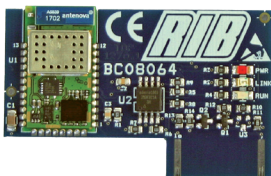
APP8064 Module Wi-Fi pour Carte APP+ pour gérer le tableau de contrôle via un réseau Wi-Fi local (WLAN)
