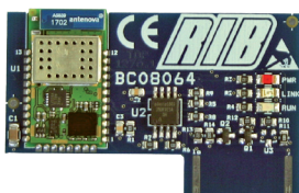
APP8064 Módulo wi-fi para Tarjeta APP+ para administrar el panel de control a través de una red Wi-Fi local (WLAN)
